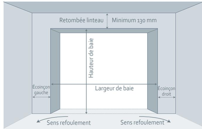
DÉTERMINATION DU SENS DE REFOULEMENT
