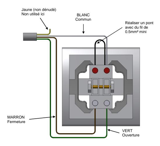
Appuyer sur l'un des boutons et dans un même temps insérer le fil dans l'une des deux cavités situées sous le bouton. Relâcher le bouton, le fil est alors pincé dans la cavité. Vérifier en tirant légèrement sur ce dernier. Réitérer la manipulation pour chacun des fils.
