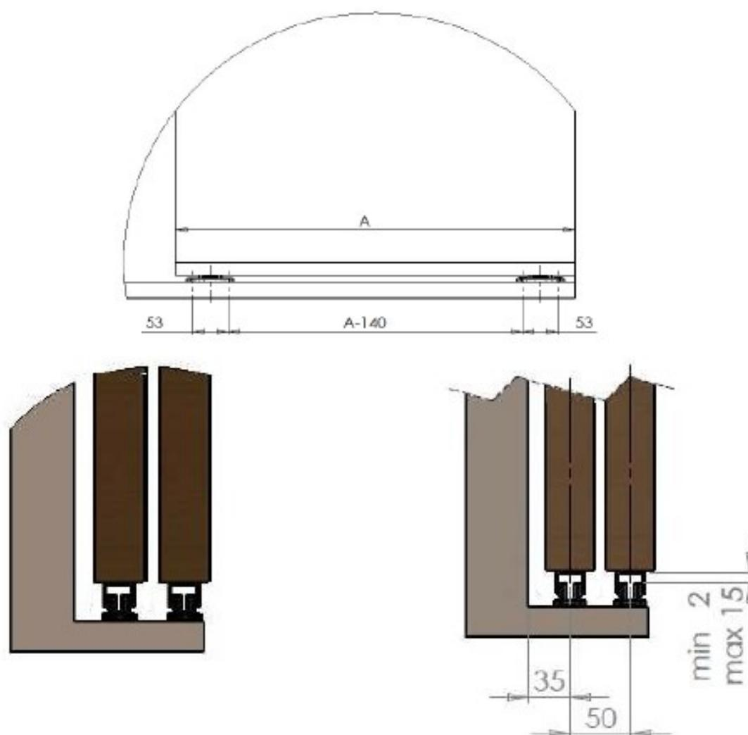
Nota : Vis pour fixation des patins de guidage au sol et U sous vantail non fournies. Il appartient au poseur de choisir la vis adaptée aux différents supports.
