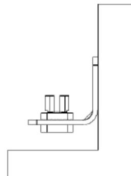
Nota : Vis pour fixation des équerres en façade non fournies. Il appartient au poseur de choisir la vis adaptée aux différents supports.
